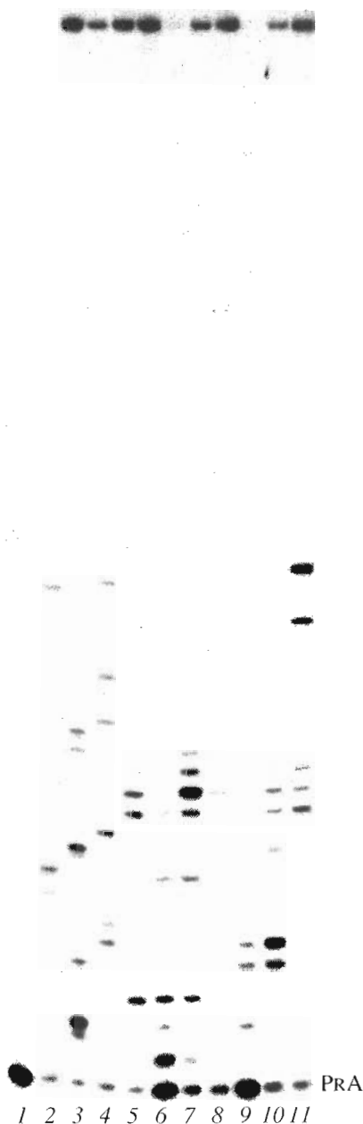
Рис. 2. Элонгация праймера, катализируемая ОТ ВИЧ в комплексе ДНК M13mp10/PRA (дорожка 1, контроль), в присутствии суммы дезоксирибонуклеотидтрифосфатов dATP, dGTP, dCTP и dTTP при концентрации каждого 0.02 (6), 0.2 (7) и 2 мкМ (8); в присутствии d(Ap 4 C) (III) и d(Tp 4 G) (VII) при концентрации каждого 0.02 (9), 0.2 (10) и 2 мкМ (11), а также терминирование синтеза ДНК в присутствии 1 мкМ дидезоксирибонуклеотидтрифосфатов: ddATP (2), ddGTP (3), ddCTP (4), ddTTP (5).
