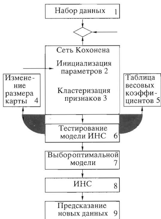
**Рис. 3.** Общая схема анализа данных с помощью алгоритма пространственного обучения. 1 – выборка исходных экспериментальных данных; 2, 3 – сеть Кохонена; 4 – блок контроля и изменения карт Кохонена; 5 – таблица весовых коэффициентов; 6 – блок тестирования модели (кластерного разбиения); 7 – блок выбора наиболее оптимальной модели; 8 – блок расчета на основе ИНС; 9 – блок прогноза новых соединений.
