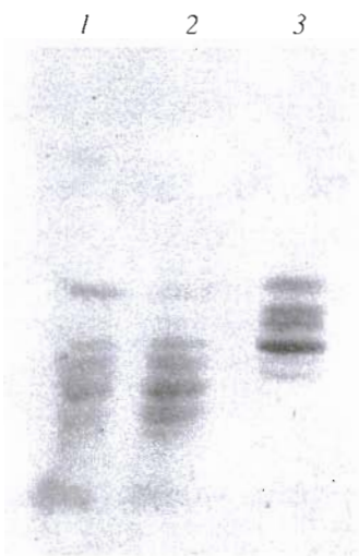
ТСХ образцов ЛА из Y. pseudotuberculosis в системе хлороформ–метанол–вода–25% аммиак, 40 : 25 : 4 : 2. Обнаружение пятен осуществляли сжиганием в парах серной кислоты. ЛА ЛПС (1), ЛА АсОН (2), ЛА НСІ (3).
