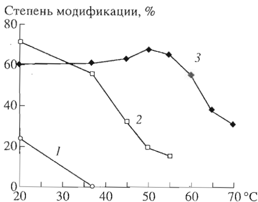
Рис. 2. Зависимость степени модификации мишени М реагентами (RCl)pN 4 +E1(Phn) (1), (RCl)pN 8 (2), (RCl)pN 12 (3) от температуры.
