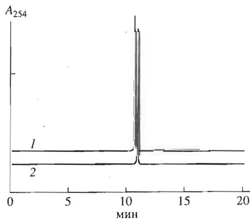
ВЭЖХ-анализ аномеров β (1) и α (2) 2'-амино-2'-дезоксиденозина. ВЭЖХ проводили на колонке Silasorb  $C_{18}$  (4 × 150 мм, размер частиц сорбента 5 мкм). Элюировали соединения в линейном градиенте концентрации ацетонитрила (0 → 50% за 20 мин в 0.05 М  $KH_2PO_4$  и 0.05 М  $NH_4Cl$ , pH 5.0). Жидкостный хроматограф – Gilson (Франция). Скорость потока 0.7 мл/мин; давление 70 бар. Время удерживания β-аномера 10.8 мин, α-аномера – 11.2 мин.
