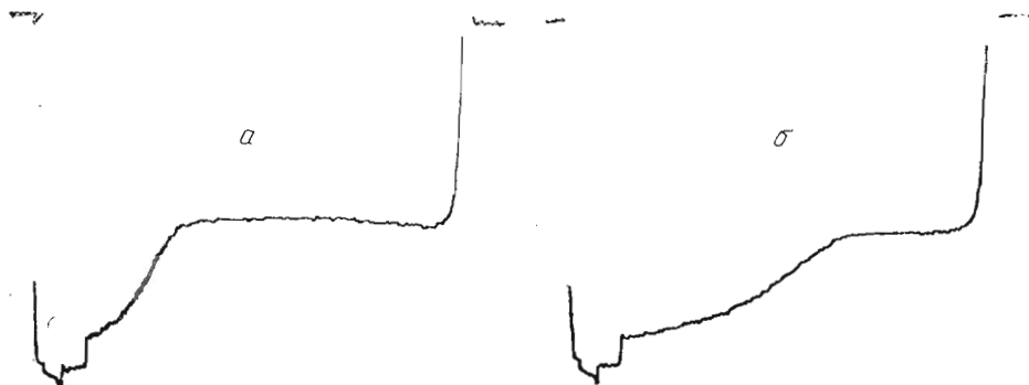
Рис. 2. Седиментационные диаграммы очищенного препарата фермента. Скорость вращения ротора 56 100 об/мин, концентрация белка 45 мкг/мл. Снимки сделаны через 33 мин (а) и через 94 мин (б) после достижения полной скорости
