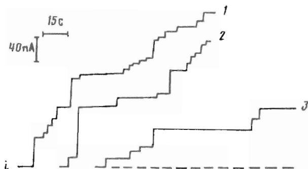
Рис. 2. Запись флуктуаций тока через БЛМ (1% олеоилглицерин в n -гептане) в присутствии 0,1 мкг/мл иерсинина: YER 3 -I (1) и YER 3 -II (2, 3). Водная фаза: 0,1 М NaCl, 5 мМ трис-HCl-буфер, рН 8,0; 25° С; потенциал на мембране — 10 мВ
