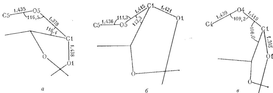
Усредненные значения геометрических параметров ацетального фрагмента в производных сахаров, 1,2-*цис*-сочлененных с диоксолановым кольцом, структурного типа I (2e1a) — а, II (2a1e) — б, III — в
