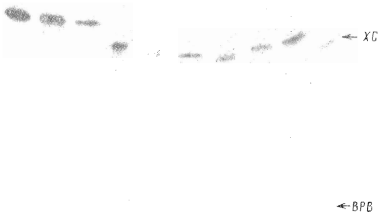
Рис. 2. Проверка гомогенности синтетических олигонуклеотидов, входящих в состав гена, электрофорезом в 10% денатурирующем акриламидном геле. Арабскими цифрами показано число мономерных звеньев в каждом олигонуклеотиде. ХС и ВРВ – положения маркерных красителей ксиленицианола FF и бромфенолового синего в геле
